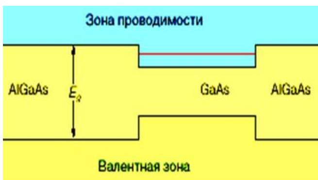
Квантовая яма на базе структуры n-AlGaAs / i-GaAs / SI-GaAs
