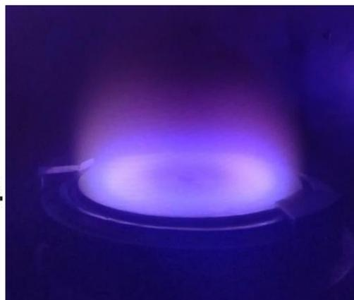
Преимущества магнетронного распыления: высокая скорость распыления при небольших давлениях рабочего газа, отсутствие перегрева подложки, малая степень загрязнения пленок примесями, возможность получения пленок равномерных по толщине.
