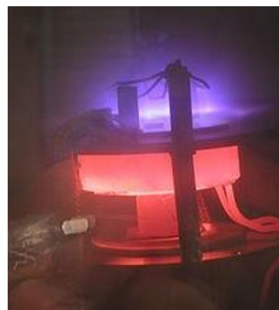
В PECVD используются аналогичные CVD-методу химические реакции, но из-за активации плазмой тлеющего разряда необходимые для их протекания температуры снижаются до 200 С. Такой подход позволяет преодолеть основной указанный выше недостаток CVD-метода - требование высоких температур. Однако при этом практически невозможно получение покрытий с очень высокой чистотой химического состава.
