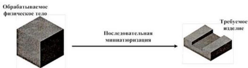
Процесс формирования наноструктур по принципу **«сверху-вниз»** предусматривает обработку макромасштабного объекта или структуры и постепенное уменьшение их размеров, вплоть до **получения изделий с нанометровыми параметрами, методами литографии и нанолитографии.**
